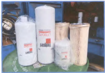
RTG 001 วันที่ 27 สิงหาคม 2567 ตรวจสภาพ 1000 ชั่วโมง เปลี่ยนถ่ายน้ำมันเครื่อง หลังทำ
