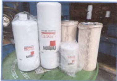
RTG 001 วันที่ 7 สิงหาคม 2567 ตรวจสภาพ 250 ชั่วโมง ครั้งที่ 3 เปลี่ยนถ่ายน้ำมันเครื่อง หลังทำ
