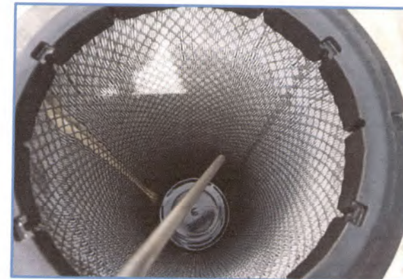
RTG 001 วันที่ 7 สิงหาคม 2567 ตรวจสภาพ 250 ชั่วโมง เป่าทำความสะอาดกรองอากาศ
