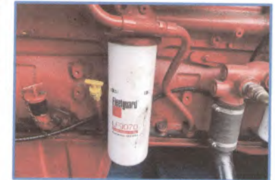
RTG 001 วันที่ 7 สิงหาคม 2567 ตรวจสภาพ 250 ชั่วโมง ครั้งที่ 3 เปลี่ยนถ่ายน้ำมันเครื่อง ก่อนทำ
