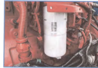
RTG 001 วันที่ 7 สิงหาคม 2567 ตรวจสภาพ 250 ชั่วโมง ครั้งที่ 3 เปลี่ยนถ่ายน้ำมันเครื่อง ก่อนทำ
