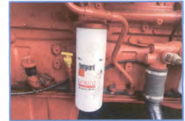
RTG 001 วันที่ 27 สิงหาคม 2567 ตรวจสภาพ 1000 ชั่วโมง เปลี่ยนถ่ายน้ำมันเครื่อง ก่อนทำ
