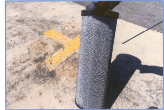
RTG 001 วันที่ 27 สิงหาคม 2567 ตรวจสภาพ 1000 ชั่วโมง เป่าทำความสะอาดกรองอากาศ
