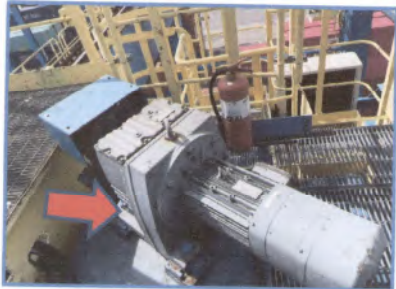
RTG 001 วันที่ 27 สิงหาคม 2567 ตรวจเช็คน้ำมันเกียร์ Skew จำนวน 4 ลูก
