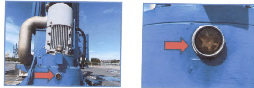
RTG 001 วันที่ 21 สิงหาคม 2567 ตรวจเช็คน้ำมันเกียร์รถกลับถ่อ จำนวน 4 ลูก
