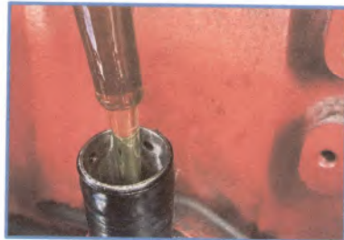
RTG 001 วันที่ 7 สิงหาคม 2567 ตรวจสภาพ 250 ชั่วโมง ครั้งที่ 3 เปลี่ยนถ่ายน้ำมันเครื่อง หลังทำ
