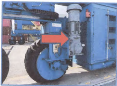
RTG 001 วันที่ 13 สิงหาคม 2567 ตรวจเช็คน้ำมันเกียร์ Gantry จำนวน 4 ลูก
