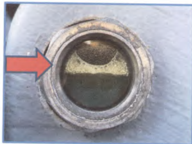
RTG 001 วันที่ 13 สิงหาคม 2567 ตรวจเช็คน้ำมันเกียร์ Gantry จำนวน 4 ลูก
