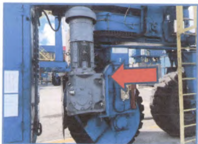
RTG 001 วันที่ 7 สิงหาคม 2567 ตรวจเช็คน้ำมันเกียร์ Gantry จำนวน 4 ลูก
